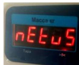
5.2 В случае подключения весов при помощи кабеля USB-RS232 с помощью клавиши [Ввод] или [Реж] входим в режим настройки весов. Отображается "VESoV". С помощью кнопки [Т] найдите и выберите тип канала обмена данными. В момент отображения на весовом дисплее сообщения "net", нажмите клавишу [+]. С помощью кнопки [Т] выберите канал обмена данных "nEtrS". Для подтверждения выбора, нажмите клавишу [Ввод] или [Реж].
