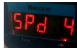
4. С помощью клавиши [Ввод] или [Реж] входим в режим настройки весов. Отображается "VESoV". С помощью кнопки [Т] найдите и выберите режим выбора протокола обмена. В момент отображения на весовом дисплее сообщения "PRoT", нажмите клавишу [+].
